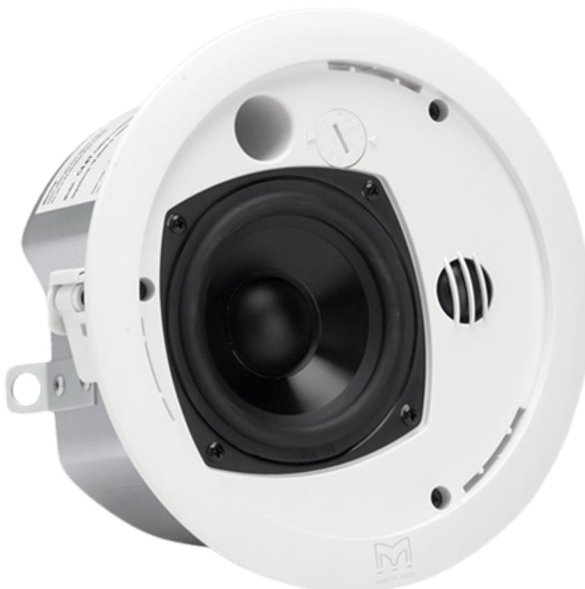
C4.8T - чрезвычайно компактный двухполосный громкоговоритель для скрытого монтажа, разработанный для обеспечения высокой производительности и высокой разборчивости в широком диапазоне применений. Устройство состоит из 4-дюймового (100 мм) НЧ-динамика с полипропиленовым диффузором с углеродным волокном с номиналом UL и купольного твитера 0,8 "(19 мм), установленного рядом на перегородке.
