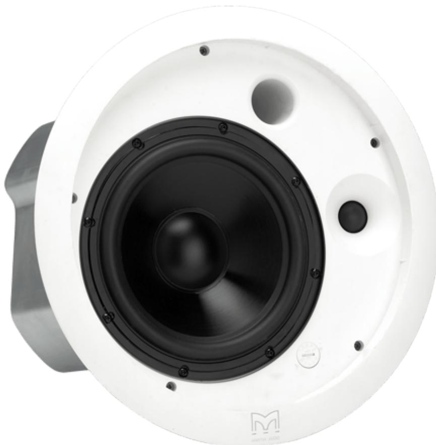
C8.1T был специально разработан для высоких потолков, где его высокая способность SPL и контролируемая дисперсия 90 ° позволяют ему обеспечивать отличную разборчивость в более реверберирующих помещениях. Он оснащен 8-дюймовым (200-миллиметровым) блоком с полипропиленовым диффузором, загруженным углеродным волокном, и 1-дюймовым (25-миллиметровым) рупорным твитером с вертикальной загрузкой, установленным рядом для оптимального рассеивания и плавного отклика вне оси.
