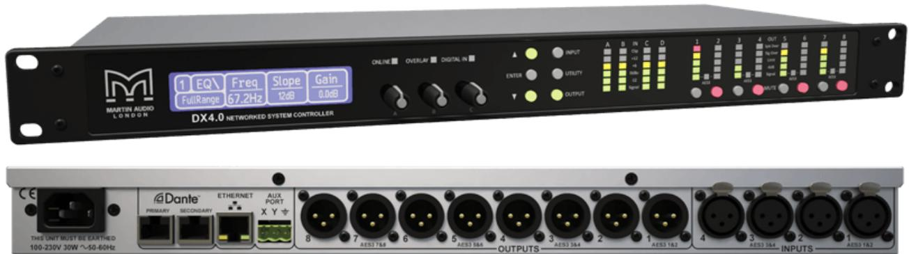
Martin Audio DX4.0 - это усовершенствованный контроллер громкоговорителей и системная матрица с четырьмя входными и восемью выходными каналами. Ведущие в своем классе характеристики звучания достигаются благодаря современным аудиопреобразователям и алгоритмам DSP с частотой дискретизации 96 кГц, обеспечивающей номинально ровную характеристику выше 40 кГц.
